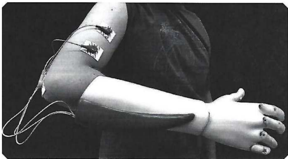
FIGURA 3: Prótese biônica mioelétrica transradial, produzida em impressão 3D.
